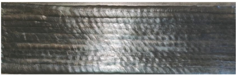
图 4 最优工艺条件下堆焊涂层表面形貌
